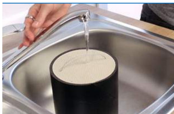
Auswaschen des Keramikwärmespeichers
