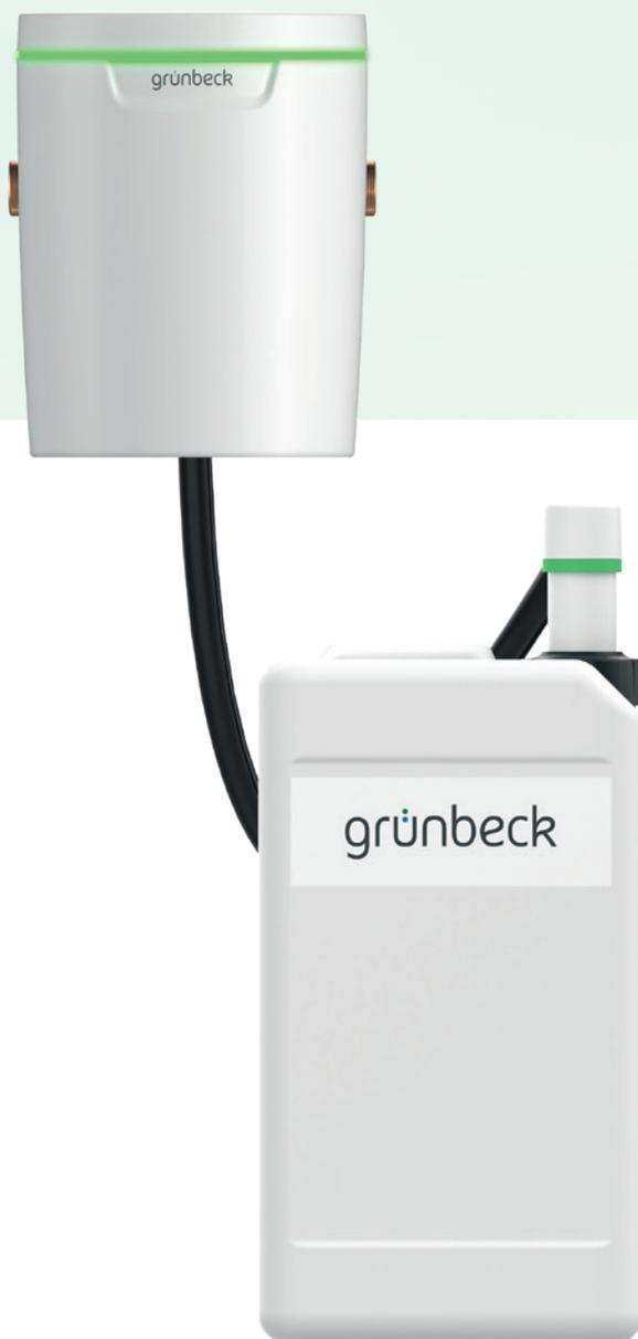
Bei der Baureihe **exaliQ:SC** handelt es sich um Sauglanzengeräte, bei denen der Dosierbehälter neben der Anlage separat am Boden aufgestellt wird. Die Mineralstofflösung wird mittels Sauglanze aus dem Behälter entnommen und durch die Pumpeneinheit des exaliQ in die Rohrleitung dosiert.
