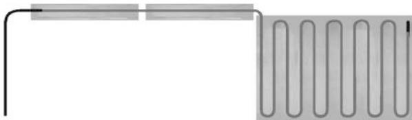
Bei Anpassung direkt nach der Anschlussleitung den Heizleiter nicht ins Installationsrohr ziehen.
