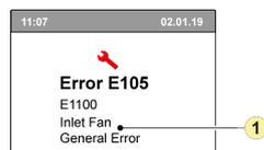
1. Zuluftventilator defekt
