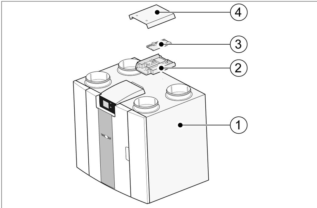
1 = CWL-Gerät mit montierter Basisplatine
