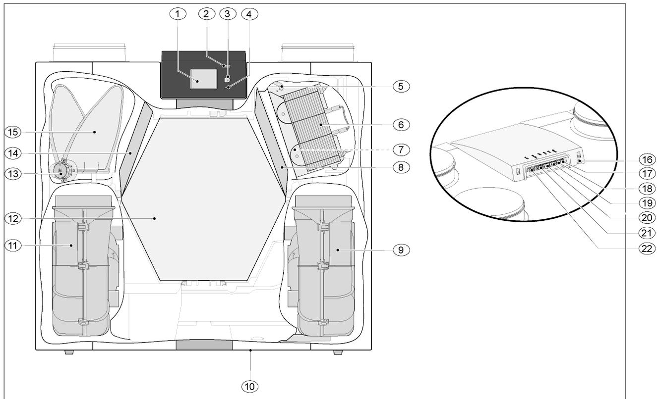
Das oben gezeigte Gerät ist eine Linksausführung; bei einer Rechtsausführung sind Vorheizregister und Bypassklappe gespiegelt montiert!
