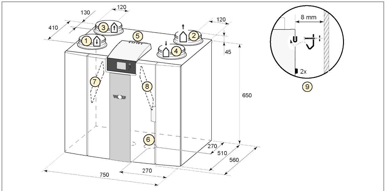
Alle Abmessungen sind in mm angegeben. Der Durchmesser der Bundringe beträgt 160 mm.
