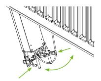
3. Lüfterbank von oben und unten mit einem Pinsel reinigen, anfallenden Staub mittels Staubsauger entfernen.
