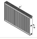
Eine seitliche Abdeckung leicht schräg vom HK abziehen (siehe Bild) und diese nach Anheben der oberen Abdeckung von den Befestigungshaken lösen.
