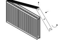
Danach die obere Abdeckung durch einseitiges Anheben und Verschieben von der zweiten seitlichen Abdeckung trennen.
