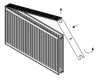
2. Reinigung des Heizkörpers von oben: je nach Länge jeweilige Lüfterbank nach oben raus ziehen, Heizkörper innen mit Reinigungsbürste reinigen. (Art.Nr.: ZK00130001)
