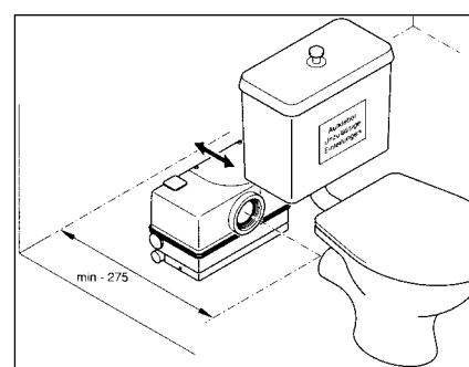
Posizionare la WCfix 260 già montata dietro al sanitario. Spingere la stazione con il manicotto di gomma DN 100 fino a battuta (nell'apertura del tubo di entrata del contenitore) sul bocchettone di scarico del WC.
