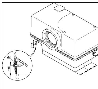
La stazione WCfix 260 viene fissata al pavimento utilizzando le viti a occhiello, i tasselli e le viti per lamiera che compongono il kit di accessori forniti in dotazione.
