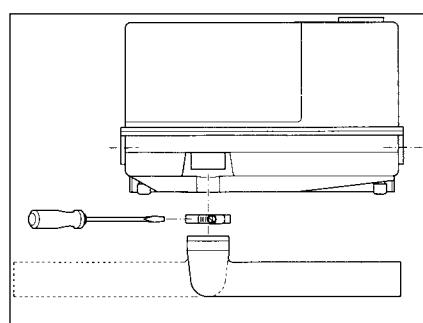
De afvoerbocht met de klem op de drukafvoerleidingen van de installatie schuiven, gewenste richting kiezen en dan met de klem bevestigen. Let er op dat de afvoerbocht volledig op de leidingen geschoven wordt om een veilige zitting van de klem te waarborgen.
