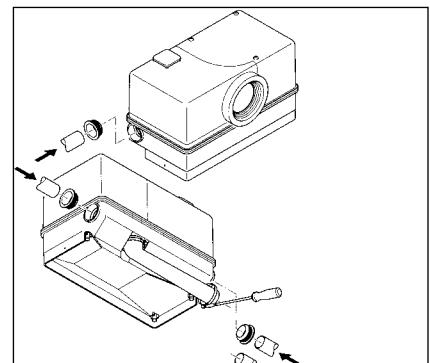
Insteekdichting(en) kort in de toevoermof steken. Aansluitend de toevoerleiding(en) tot aan de aanslag in de insteekdichting van de toevoermof schuiven. De afvoerbocht met een klem over de persleiding schuiven en bevestigen.
