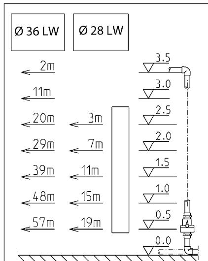
DE - Max. waagerechte Druckleitungslänge inkl. 2 Winkel und Rückschlagklappe 1½"
