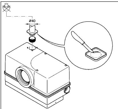
Anschluss einer Lüftungsleitung über Dach.
