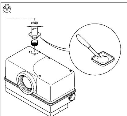
Aansluiting van een verluchtingsleiding via het dak.
