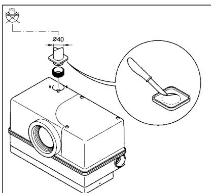
Raccordement d'un conduit d'aération par le toit.
