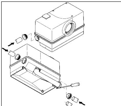
Enfoncer le(s) joint(s) emboîté(s) dans le manchon d'arrivée de façon à former une surface plane. Insérer ensuite la(les) conduite(s) d'arrivée jusqu'à la butée dans le joint emboîté du manchon d'arrivée. Pousser le coude de sortie avec un collier sur la conduite de refoulement et le fixer.
