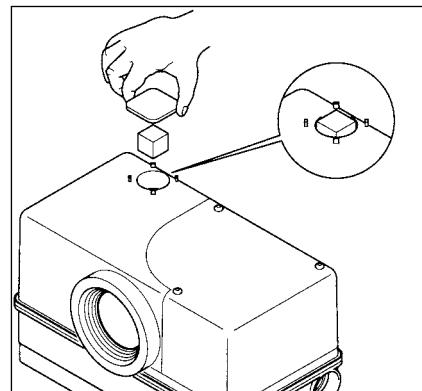
Hiervoor wordt de kap voor de ontluuchting van het reservoir afgenoem. Het uitgepakte actiekoolfilter moet in de cilindrische opening gedrukt worden. Het actiekoolfilter is iets groter van afmeting wat voor een veilige zitting in de opname zorgt. De hoeken van het filter worden hierbij lichtjes ageschuurde. Aansluitend kap opnieuw opdrukken. Een filterwissel moet in het bijzonder na storingen met wateruitloop door het verluchtingsventiel, bij geurbelasting, doch minstens 1x per jaar gebeuren.
