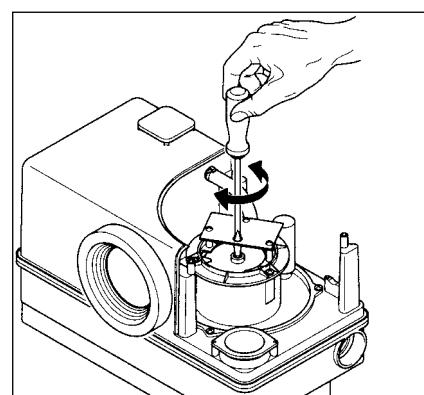
2. Bei eventueller Blockierung der Pumpe wird mit Hilfe eines Schraubendrehers, durch das entsprechende Loch in der Platine, die geschlitzte Motorwelle gedreht, bis die Welle sich frei drehen lässt. Haube wieder montieren.
