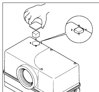
Dazu wird die Kappe für Entlüftung vom Behälter abgenommen. Der ausgepackte Aktivkohlefilter ist in die zylindrische Öffnung zu drücken. Der Aktivkohlefilter hat etwas Übermaß, das für sicheren Sitz in der Aufnahme sorgt. Die Ecken des Filters scheren dabei leicht ab. Anschließend Kappe wieder aufdrücken. Ein Filterwechsel sollte insbesondere nach Störungen mit Wasseraustritt durch das Lüftungsventil, bei Geruchsbelästigung, mindestens jedoch 1x jährlich erfolgen.
