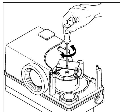
2. Bij eventuele blokkering van de pomp wordt met behulp van een schroevendraaier, door het overeenkomstige gat in de platine, de ggleufde motoras gedraaid, tot de as vrij kan draaien. Kap opnieuw monteren.
