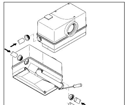
Steckdichtung(en) bündig in die Zulaufmuffe stecken. Anschließend die Zulaufleitung(en) bis zum Anschlag in die Steckdichtung der Zulaufmuffe einschieben. Den Abgangskrümmer mit einer Schelle über die Druckleitung schieben und befestigen.
