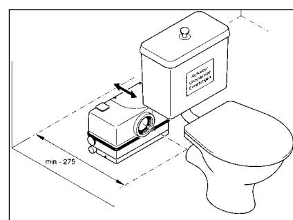
Positionner le WCfix 260 prémonté derrière la cuvette des toilettes. Pousser le dispositif avec le joint en caoutchouc DN 100 jusqu'à la butée (dans l'ouverture d'arrivée du collecteur) sur la tubulure d'évacuation des toilettes.
