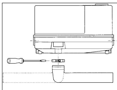
Spingere la curva di scarico provvista della fascetta sul bocchettone di uscita a pressione dell'impianto, scegliere la direzione desiderata e fissare con la fascetta. Accertarsi che la curva di scarico venga spinta completamente sul bocchettone in modo da garantire una sede sicura alla fascetta.
