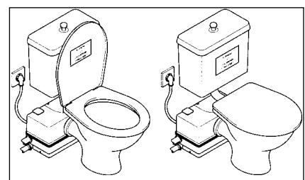
De WCfix 260 wordt met behulp van de zich in het meegeleverde pakket bevindende oogschroeven, tap en plaatsschroeven tegen verschuiven en bovendrijven beveiligd.
