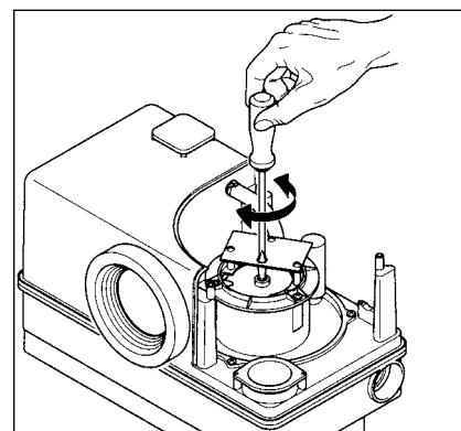
2. Si la pompe est bloquée, veuillez utiliser un tournevis, l'enfoncer dans le trou correspondant de la platine et faire pivoter l'arbre moteur rainuré jusqu'à ce que l'arbre tourne librement. Monter de nouveau le capot.
