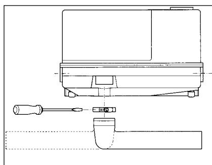
Den Abgangskrümmer mit der Schelle auf den Druckabgangsstutzen der Anlage schieben, gewünschte Richtung wählen und dann mit der Schelle befestigen. Achten Sie darauf, dass der Abgangskrümmer vollständig auf den Stutzen geschoben wird um einen sicheren Sitz der Schelle zu gewährleisten.
