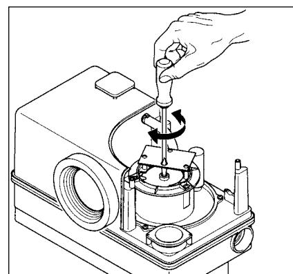
2. In caso di blocco della pompa, inserire un cacciavite nel foro della piastrina e ruotare l'albero motore scanalato fino a quando non gira liberamente da solo. Rimontare il rivestimento protettivo.
