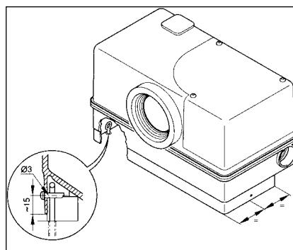
De voorgemonteerde WCfix 260 achter het toiletbekken plaatsen. De installatie met de gummi manchette DN 100 tot aan de aanslag (in de toevoeropening van het reservoir) op de toiletafvoerleidingen schuiven.
