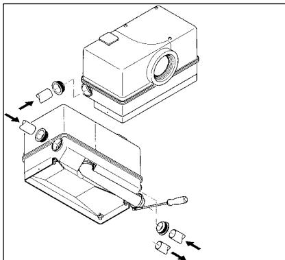
Montare a filo la(e) guarnizione(i) a incastro nel raccordo di entrata, dopodiché inserire la(e) condutture(e) di adduzione nella guarnizione a incastro del raccordo di entrata fino a battuta. Spingere la curva di scarico munita di fascetta sopra alla tubazione di manda-ta e fissarla in posizione.
