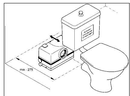
Soll ein Waschbecken, eine Dusche und/oder ein Bidet angeschlossen werden, ist der entsprechende Stopfen im Zulauf zu entfernen. Die Installationshinweise Höhen, Gefälle und Anordnung sind zu beachten.
