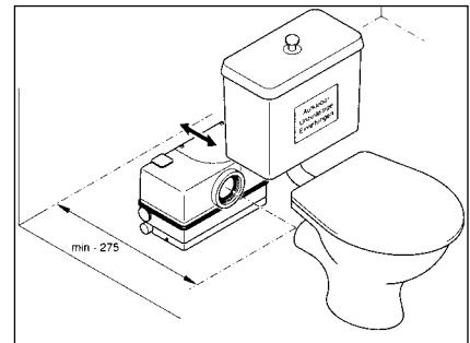
Indien een wasbekken, een douche en/of een bidet aangesloten worden, moet de overeenkomstige stop in de toevoer verwijderd worden. De installatie-instructies hoogten, verlopen en aansluitingen moeten nageleefd worden.
