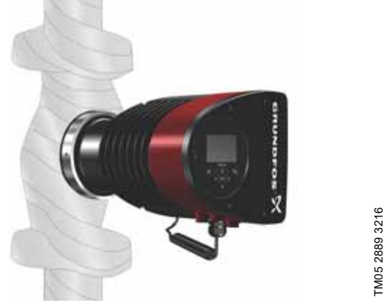
Abb. 4 Dämmen des Pumpengehäuses und der Rohrleitung bei einer Heizungsanlage
