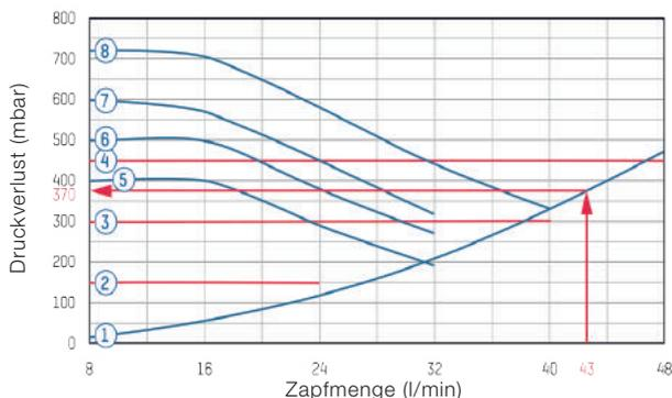
Beispiel zur Interpretation der Durchfluss- und Druckverlust Diagramme
