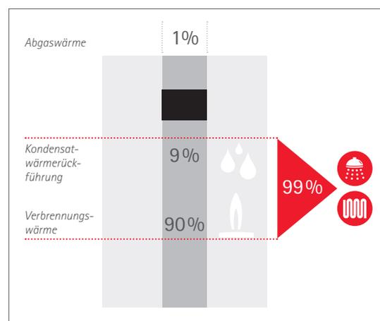
Bevor die Abgase durch den Schornstein abgeführt werden, wird ihnen die Wärme über einen Kondensationswärmetauscher nahezu komplett entzogen und in den Heizkreislauf zurückgeführt. Mit ca. 40 °C ist die Abgastemperatur dann nur noch so hoch, dass die Abgase problemlos abgeführt werden können.
