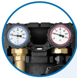
Kombihähne mit Thermometer im Handrad, Anzeigebereich 0/120 °C. Rote/blau Kennung erleichtert die Zuordnung „Vorlauf-/Rücklaufstrang“ und Funktionskontrolle für den Anlagenbetreiber.
