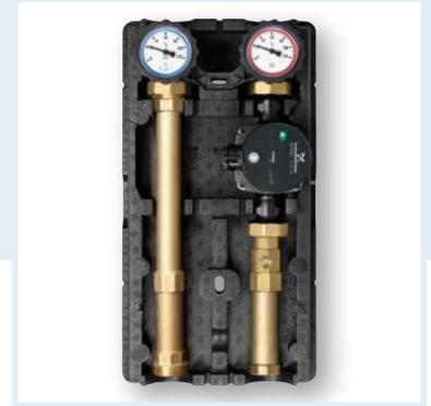
**Anwendung** Heizungspumpengruppe zur Verwendung in ungemischten Heizkreisen, speziell auch zur Speicherladung. Sie bildet die Verbindung zwischen Heizkessel und Rohrleitungssystem.
