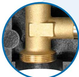
Systemanschluss G1½ außen zur schnellen Montage an den Kesselvor- bzw. rücklauf über Flansch und Überwurfmutter. Passend für KSV.
