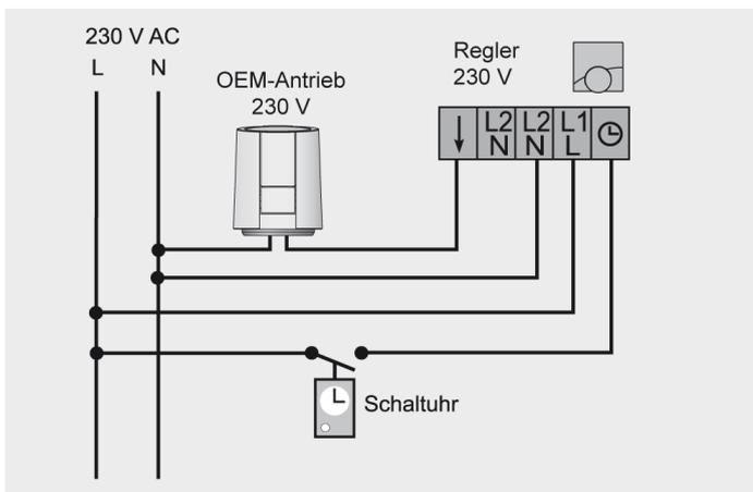
Für die Installation einer 230 V-Anlage empfehlen wir folgende Leitungen:
