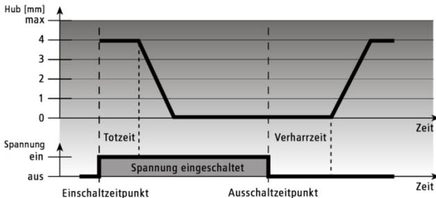
Bei der Ausführung stromlos-auf wird beim Einschalten der Betriebsspannung – nach Ablauf der Totzeit – das Ventil durch die Stößelbewegung gleichmäßig geschlossen.
