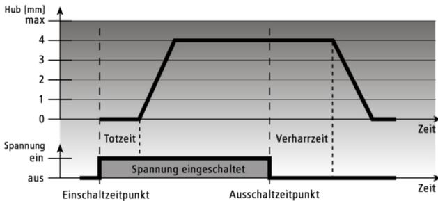
Bei der Ausführung stromlos-zu wird beim Einschalten der Betriebsspannung – nach Ablauf der Totzeit – das Ventil durch die Stößelbewegung gleichmäßig geöffnet.
