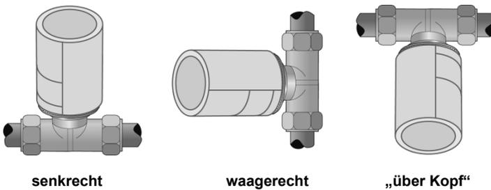
Der OEM-Antrieb ist bevorzugt in senkrechter oder waagerechter Montagelage einzubauen. Bei „über Kopf“-Montage können spezielle Umstände (z.B. Schmutzwasser) die Lebensdauer reduzieren.
